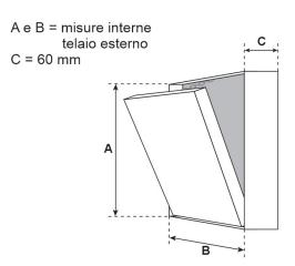
Foro Luce Sistema MW: misura sportello - 36 mm Foro muro: misura sportello + 5 mm
